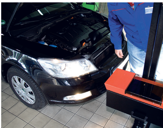
Kontrola svjetala uz pomoć regloskopa
